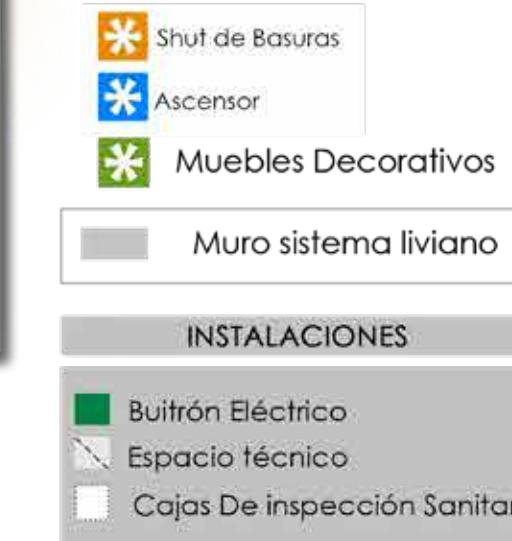
Este buitrón será usado para la conducción de redes: eléctricas, sanitarias, hidráulicas y de gas con la posibilidad de ubicar cajas de paso al exterior o medidores.
